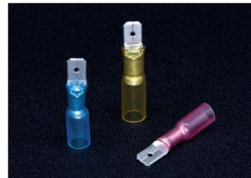
Клеммы термоусадочные «папа» изготовлены из прозрачного термоусаживающего нейлона с внутренним слоем термоплавкого клея для защиты соединений от воды и коррозии. Клеммы хорошо соединяют и защищают электрические соединения, устойчивы к вибрации. Тело клеммы изготовлено из латуни высокого качества, что обеспечивает хорошую проводимость. Термоусадочные клеммы обеспечивают более длительную защиту соединения, простоту и низкую стоимость установки, которая более надежна, чем обычные обжимные клеммы.
