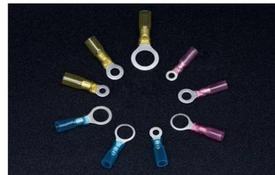
Клеммы термоусадочные кольцевые изготовлены из прозрачного термоусаживающего нейлона с внутренним слоем термоплавкого клея для защиты соединений от воды и коррозии. Клеммы хорошо соединяют и защищают электрические соединения, устойчивы к вибрации. Тело клеммы изготовлено из меди высокой чистоты, что обеспечивает хорошую проводимость. Термоусадочные клеммы обеспечивают более длительную защиту соединения, простоту и низкую стоимость установки, которая более надежна, чем обычные обжимные клеммы.
