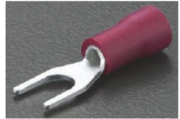
Клеммы вилочные изготовлены с изоляцией из ПВХ. Клеммы хорошо соединяют и защищают электрические соединения, устойчивы к вибрации. Тело клеммы изготовлено из меди высокой чистоты, что обеспечивает хорошую проводимость. Клеммы обеспечивают длительную работу, простоту установки, низкую стоимость установки и высокую надежность.
