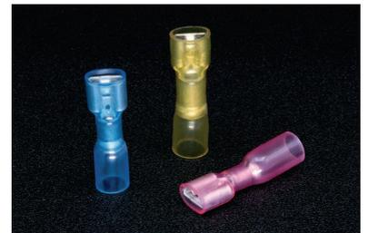
Клеммы термоусадочные «мама» изготовлены из прозрачного термоусаживающего нейлона с внутренним слоем термоплавкого клея для защиты соединений от воды и коррозии. Клеммы хорошо соединяют и защищают электрические соединения, устойчивы к вибрации. Тело клеммы изготовлено из качественной латуни, что обеспечивает хорошую проводимость. Термоусадочные клеммы обеспечивают более длительную защиту соединения, простоту и низкую стоимость установки, которая более надежна, чем обычные обжимные клеммы.
