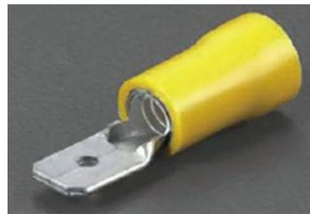
Клеммы плоские изолированные «папа» изготовлены с изоляцией из ПВХ. Клеммы хорошо соединяют и защищают электрические соединения, устойчивы к вибрации. Тело клеммы изготовлено из латуни, что обеспечивает хорошую проводимость. Клеммы обеспечивают длительную работу, простоту установки, низкую стоимость установки и высокую надежность.
