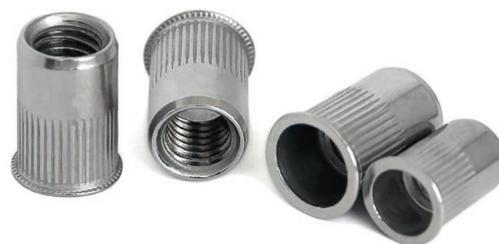
**Применение:** устанавливается, когда требуется маленький зазор между крепёжными элементами или элементы могут соприкасаться. Используется для организации резьбового соединения в тонких материалах, где создание резьбы непосредственно в материале невозможно из-за его маленькой толщины, например, в листах металла. Продольное рифление на наружной поверхности предотвращает проворачивание заклепки после установки.
