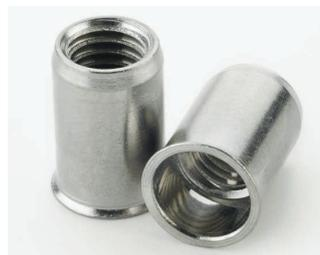
**Применение:** устанавливается, когда требуется маленький зазор между крепёжными элементами или элементы могут соприкасаться. Используется для организации резьбового соединения в тонких материалах, где создание резьбы непосредственно в материале невозможно из-за его маленькой толщины, например, в листах металла.
