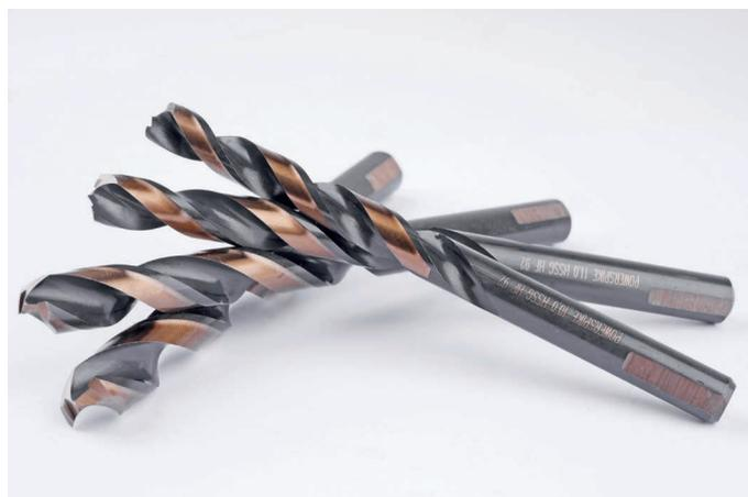
Сверла **POWERSPIKE** специальная геометрия заточки. Эти шлифованные сверла производятся из высоколегированной стали HSS (W6M5Cr4V2). Сверла GSR Powerspike меньше нагреваются при сверлении, поэтому имеют большую производительность. Благодаря самоцентрирующейся заточке нет необходимости в использовании кернера
