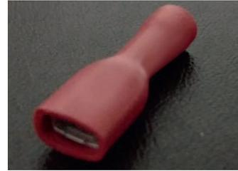
Клеммы плоские изолированные «мама» изготовлены с изоляцией из ПВХ. Клеммы хорошо соединяют и защищают электрические соединения, устойчивы к вибрации. Тело клеммы изготовлено из латуни, что обеспечивает хорошую проводимость. Клеммы обеспечивают длительную работу, простоту установки, низкую стоимость установки и высокую надежность
